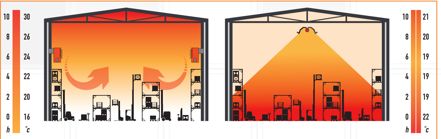
Sıcak hava üflemleri sistemlerde mekanın üst kısmındaki kullanılmayan hacim daha sıcaktır ve çatıdan ısı transferi çok fazladır.
